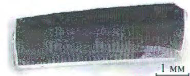
Поперечный шлиф образца расплава при охлаждении с 1180 °С в режиме I (в воде): желтое стекло — расплав, который контактировал с воздухом (верхний слой), черное стекло — расплав, который контактировал с дном тигля (нижний слой), и поликристаллическая середина ( $\delta^*-\text{Bi}_2\text{O}_3$ ).
